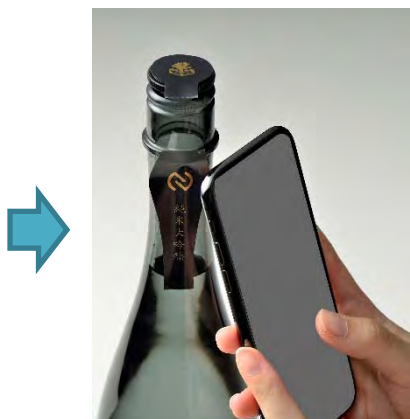
NFC 対応スマートフォンで開封状態を検知
